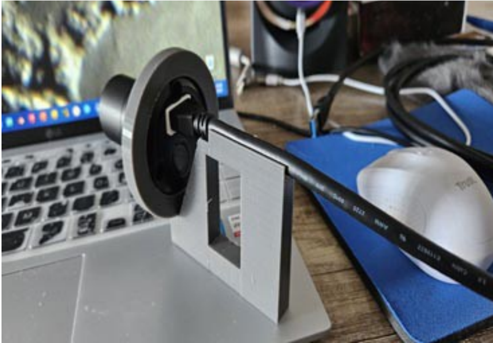
Abb. 3 Montieren der Kabelstütze
